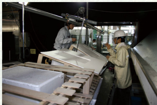
実験準備中の傾斜したモデル積雪斜面 Different inclined model slopes in preparation
