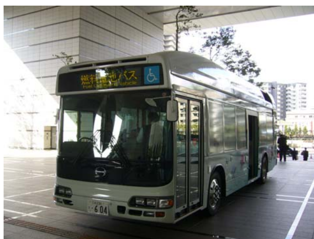
図3 燃料電池バス。水素タンクは上部にある。
