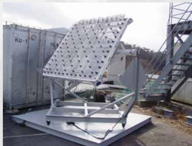
斜め方向をねらう大気レーダー Tilting system of atmospheric radar
