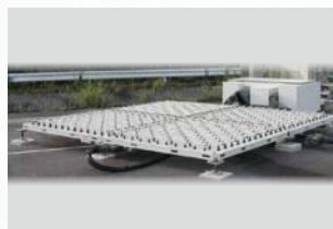
4. ウィンドプロファイラーによる高層気象観測 Atmospheric Observations with Wind Profiler
