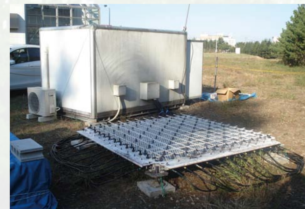
青森県六ヶ所村に設置されたウィンドプロファイラー A wind profiler installed at Rokkasho, Aomori
