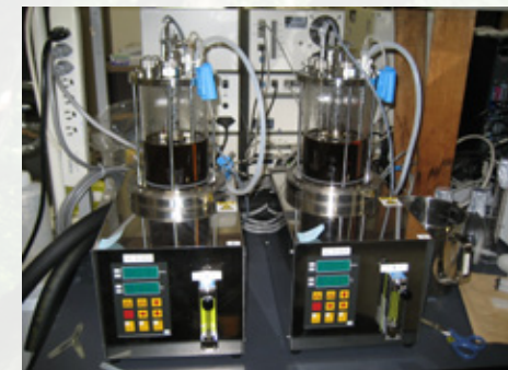
琵琶湖藻類由来の糖液からのジャーファーマンターによるバイオエタノール生産 Bioethanol production from sugar solution of algae in Lake Biwa by jar fermentor
