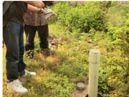
現地(インドネシア国パダン)での掘削井戸における水位観測 Observation of water level in a well installed in Padang
