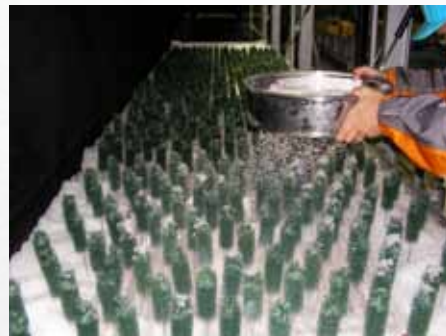
ざらめ雪を充填中の樹木模型を配置した実験台(植被率7.0%) Tree model table under granular snow filling work (forest cover index : 7.0%)
