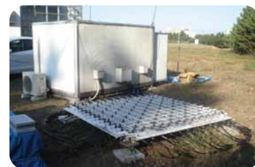
サイト型機動研究： ウインドプロファイラーによる観測（青森県） Atmospheric Observations with Wind Profiler (Aomori Site)
