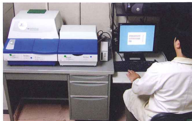
マイクロプレートリーダーによる蛍光センサーの特性評価
