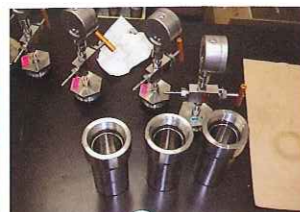
深海より採取された好圧性微生物の培養装置
