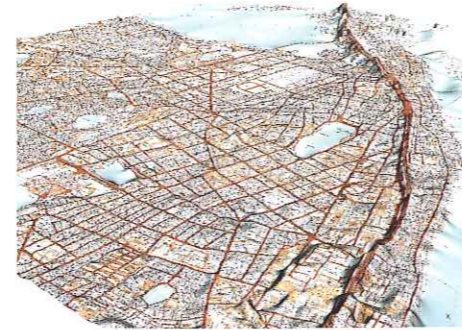
標高測量から作成したハノイのDEMの3次元可視化例
