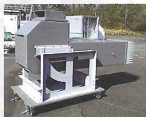
可搬・可動型に改良したRASS音波発射装置 Transportable acoustic device for RASS
